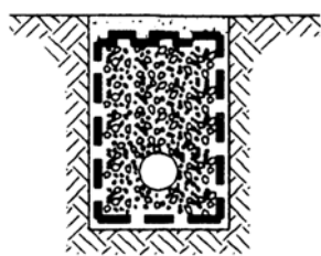
۶- اجرای خاکریز باقیمانده روی کانال و تراکم
