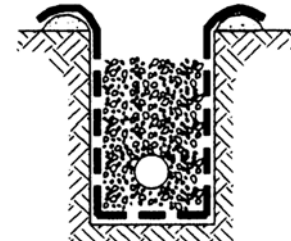
۴- ریختن مصالح زهکشی و تراکم
